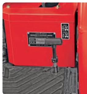
Palanca activada de tracción en las cuatro ruedas
