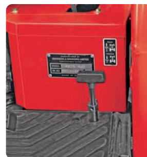
Palanca desactivada de tracción en las cuatro ruedas
